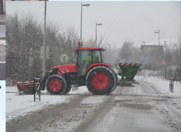
Déneigement d'une intersection: gestion du cordon de neige?
