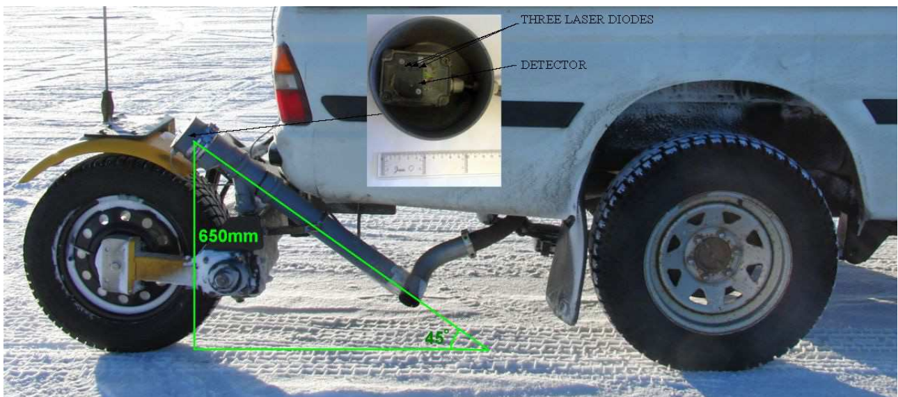
Figure 3 – RT3 et « road eye » sur le véhicule de remorquage
