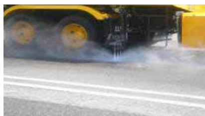
Fig. 13-Vue des jets de l'appareil auxiliaire de nettoyage des bandes de marquage
