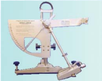
Pendule SRT – Essai suivant NF EN 14-231
