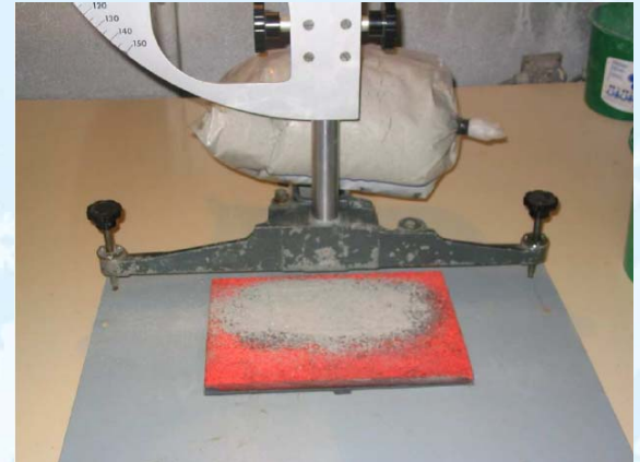
Dispositif de mesure sur réplique de chaussée, fines de NaCl Dosage 2
