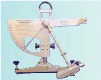
Pendule SRT – Essai suivant NF EN 14-231
