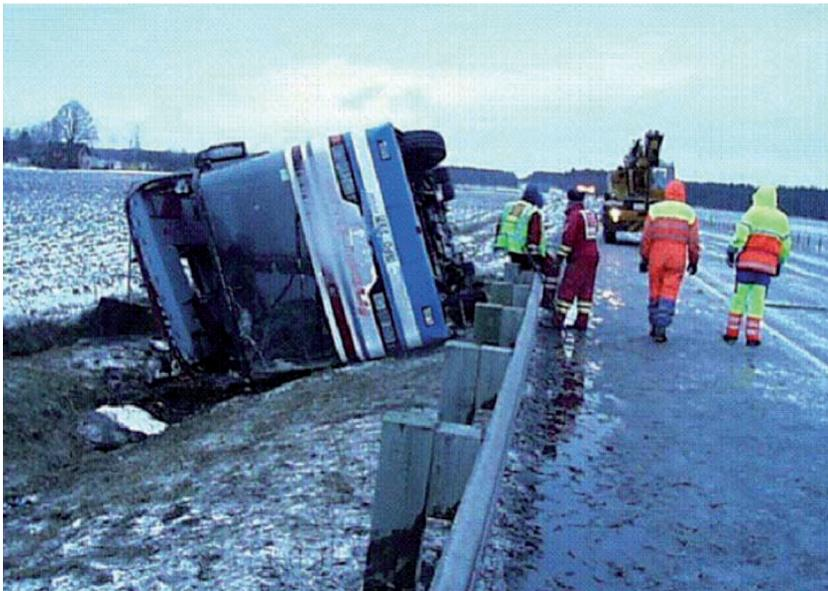
▲ Figure 5 – Accident d'autobus provoqué par une faible adhérence et un vent latéral
