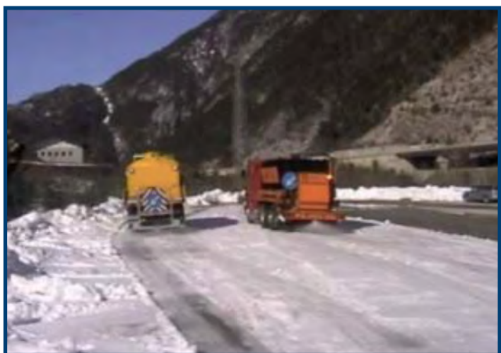
Comparaison entre camions-citernes italiens contenant des solutions de chlorure de calcium chaude et froide. La solution chaude (à gauche) a un plus grand pouvoir déglacant. / Comparison between Italian tankers containing solutions of hot and cold calcium chloride solution. The difference in the de-icing effect of the hot solution (at left) is significant.
