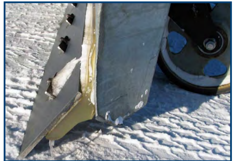
En Suède, les porte-lames d'usure flexibles et la lame de déneigement écologique posées sur le chasse-neige. / In Sweden, the flexible cutting edge mounts and the environmental plough attached to a lorry.
