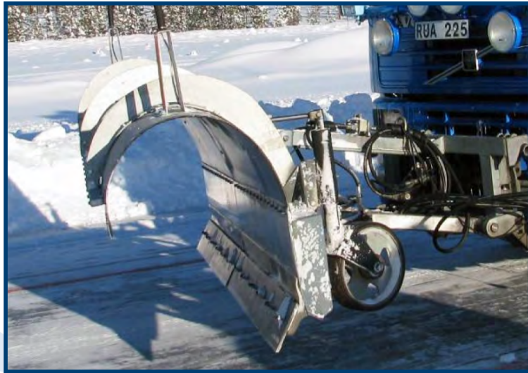
En Suède, les porte-lames d'usure flexibles et la lame de déneigement écologique posées sur le chasse-neige. / In Sweden, the flexible cutting edge mounts and the environmental plough attached to a lorry.
