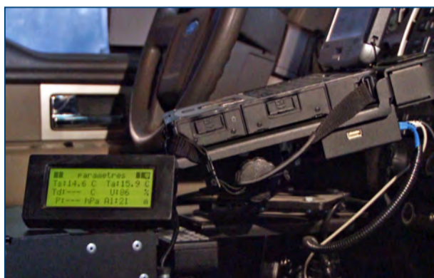
Équipement d'une station météo-routière mobile de deuxième génération. / Equipment of a second-generation mobile road weather station.
